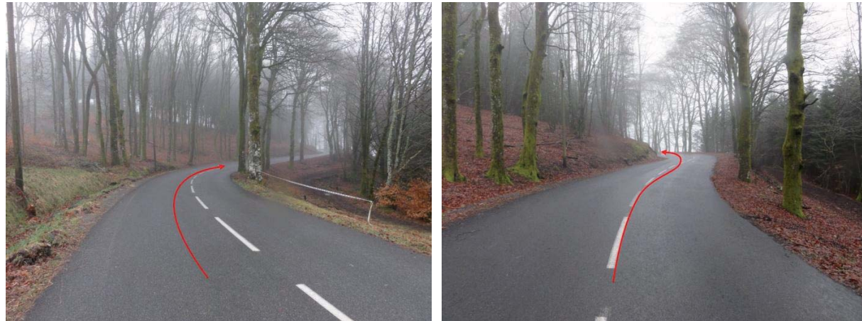
Photos 13 & 14 : Il faut certainement déboiser le côté droit de la chaussée à l'entrée du virage. Plus loin, il faut rogner l'intérieur du virage et enlever le poteau.
