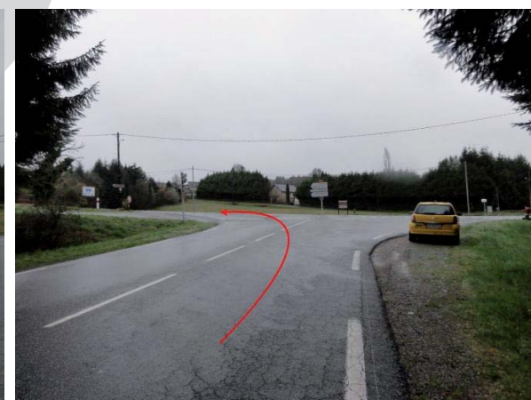
Photos 2 & 3 : Bifurcation sur la D 16. Il faut enlever soit l'arbre soit le poteau pour permettre aux transports de tourner, car les deux sont presque en face l'un de l'autre.
